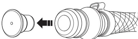
In caso di bassa pressione dell'acqua, ad es. quando l'acqua proviene da un serbatoio, è possibile rimuovere la strozzatura per ottenere il flusso d'acqua corretto.
