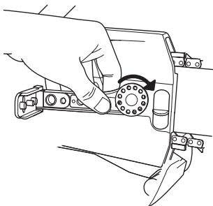
Ослабьте пружину. Держите полотно вверх при движении ручки вперед. Обратите внимание, что полной механической остановки ручки быть не должно. Остановка предотвращает направление ручки вперед и не позволяет осуществлять резку.
