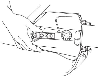
Нажмите на пружину на ручке натяжения цепи. Поверните гайку регулировки полотна против часовой стрелки.
