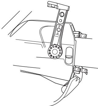
Отведите рычаг назад и вниз. Нажмите пружину в ручке натяжения цепи и поверните гайку полотна по часовой стрелке вручную.
