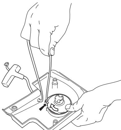
Обратите внимание! Проверьте, чтобы шкив стартера был повернут по крайней мере на половину оборота при полностью вытянутом шнуре стартера.
