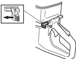
Газ в стартовой позиции – холодный двигатель: Для настройки газа в стартовой позиции и пускового устройства, необходимо полностью вытащить рычажок пускового устройства.
