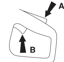
Замок триггера остается нажатым до тех пор, пока нажат дроссель. Когда вы отпускаете рукоятку, то ручка газа и фиксатор ручки газа возвращаются в свое первоначальное положение. Это осуществляется благодаря двум независимым друг от друга системам пружин. В таком положении ручка газа автоматически фиксируется на холостых оборотах.
