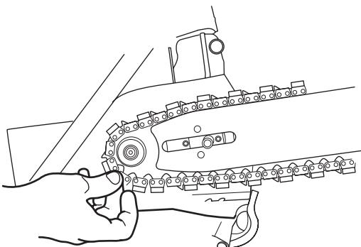
Удалите пружину, удерживающую два полукруглых элемента, с помощью отвертки.
