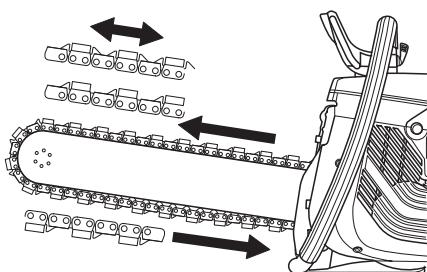
При использовании цепи с двойными скальвающими зубьями ее можно устанавливать в обе стороны. При использовании цепи с одним направлением скальвающих зубьев она должна всегда устанавливаться в нужную сторону. Скальвающие зубья должны поддерживать нужную высоту в разрезе.
