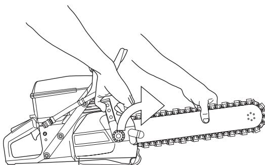
Закрепите винт для регулировки натяжения цепи.
