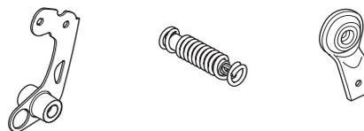
Проверьте, чтобы виброгасящие элементы были надежно закреплены на блоке двигателя и ручках.
