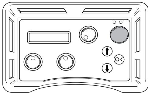
5. Säädä aggregaatin syöttövirtaus maksimiin kääntämällä kauko-ohjaimen säädintä myötäpäivään.
