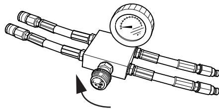
7. Start motorens rotasjon ved å vri kontrollen for motorrotasjon på fjernkontrollen med urviseren.
