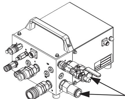
6. Om CS2512 skall användas, anslut tryckreduceringsblocket honkopplingar till hankopplingarna på RC 455.
