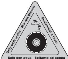
**ΠΡΟΕΙΔΟΠΟΙΗΣΗ!** Ψύξτε τους διαμαντέ δίσκους υγρής κοπής συνέχεια με νερό για να εμποδίσετε υπερθέρμανση που μπορεί να παραμόρφωσει το δίσκο με αποτέλεσμα φθορές στο μηχάνημα και τραυματισμό του χειριστή.
