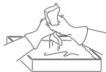
フィルターをビニール袋に入れフィルターオイルを注ぎます。ビニール袋の上から揉み解し、オイルを均一に行き渡らせます。フィルターをパワーカッターに装着する前にビニール袋の中のフィルターから余剰オイルを搾り出し、廃棄します。注意! 通常のエンジンオイルは絶対に使用しないでください。
