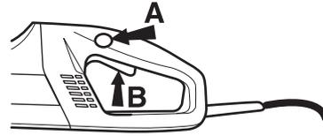
パワースイッチロックは、パワースイッチが押されている間、押された状態のままになります。ハンドルのグリップを放すと、パワースイッチとパワースイッチロックの両方がリセットされます。この動きは、2つの独立したリターンスプリングによって制御されています。この位置では、マシンが停止し、パワースイッチがロックされます。
