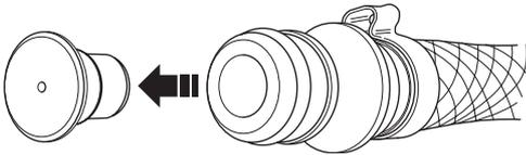
水タンクが使用されたときなど、水圧が低い場合は、制限器を外して、正しい水流にすることができます。
