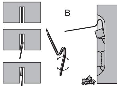
**BRĪDINĀJUMS!** Zāgējot vertikāli, vienmēr zāgējiet no zāgējuma augšas uz leju. Nekad nezāgējiet no zāgējuma apakšas uz augšu. Zāgējot šādā veidā, iekārta vai izraisīt prestitienu un radīt ievainojumus.
