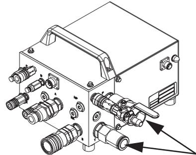
6. Se si deve utilizzare CS2512, collegare i raccordi femmina del gruppo di riduzione della pressione ai raccordi maschio di RC 455.
