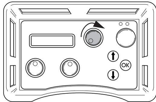
8. Verhoog voorzichtig het toerental van de motor door de knop voor motorrotatie om te draaien. Een geschikte werkdruk voor zagen is normaal tussen 100 en 130 bar, maar varieert afhankelijk van bijvoorbeeld het aantal wielparen dat in het magazijn wordt gebruikt, de hoeveelheid kabel die ingrijpt en de hardheid van het materiaal dat wordt gezaagd.
