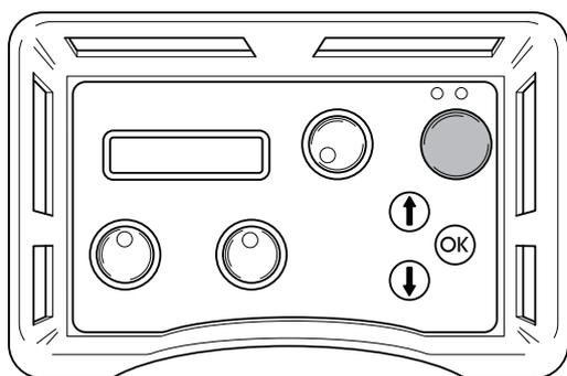
1. Girare sul massimo il comando di rotazione della lama per avviare la rotazione della lama e l'acqua di raffreddamento.
