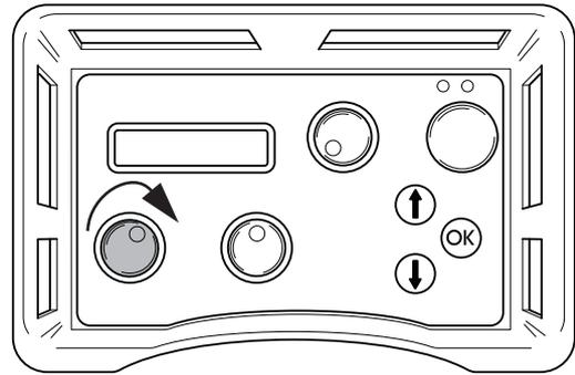
6. Spannen Sie das Seil, indem Sie den Knauf am Druckreduzierblock vorsichtig im Uhrzeigersinn drehen, bis das Seil eine mittlere Spannung aufweist. Kontrollieren Sie stets sorgfältig, dass das Seil korrekt in allen Führungen in der Säge liegt.
