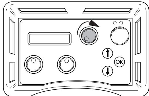
8. Steigern Sie vorsichtig die Motordrehzahl, indem Sie den entsprechenden Regler drehen. Der geeignete Betriebsdruck beim Schneiden liegt üblicherweise zwischen 100 und 130 Bar. Er variiert jedoch je nach Anzahl der Radpaare im Magazin, der vorliegenden Seilmenge, der Härte des bearbeiteten Materials usw.
