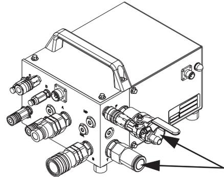
6. Wenn Modell CS2512 verwendet werden soll, verbinden Sie die Buchsenkupplungen des Druckreduzierblocks mit den Steckkupplungen an RC 455.
