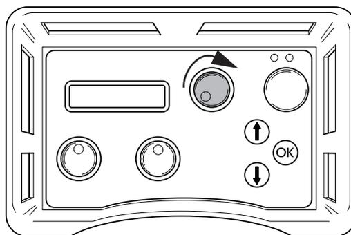
8. Aumentare gradualmente il regime del motore girando il comando di rotazione del motore. Generalmente, durante il taglio la pressione di esercizio è compresa fra 100 e 130 bar, ma può variare ad es. in base al numero di coppie di ruote utilizzate nel magazzino, alla quantità di filo inserita e alla durezza del materiale da tagliare.
