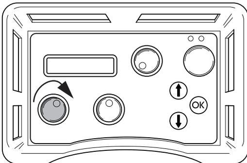
6. Span de kabel door de knop op het drukreductieblok voorzichtig met de klok mee te draaien tot de kabel voldoende strak staat. Blijf zorgvuldig controleren dat de kabel goed langs alle wielen door de zaag loopt.
