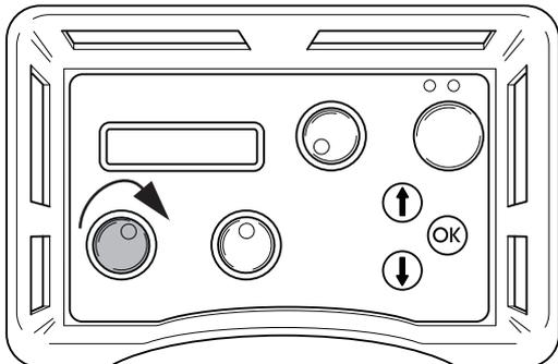
6. Tendere il filo girando con cautela la manopola sul gruppo di riduzione della pressione in senso orario finché non è sufficientemente teso. Controllare sempre che il filo sia posizionato correttamente su tutte le ruote della mototroncatrice.
