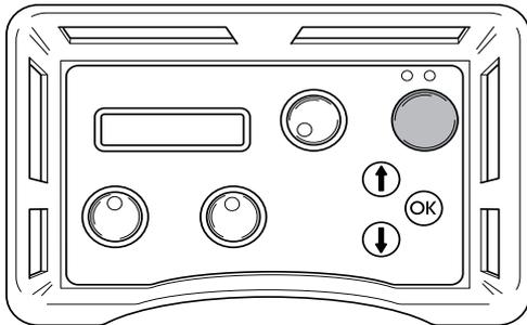
5. Stellen Sie den Versorgungsdurchfluss am Aggregat auf maximal, indem Sie den Regler an der Fernsteuerung im Uhrzeigersinn drehen.
