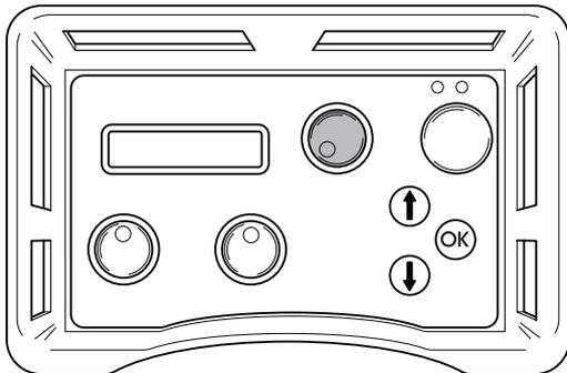
2. Durch Drehen des Tiefenvorschubbrads an der Fernsteuerung den Tiefenvorschub starten.
