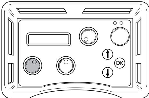
3. Durch Drehen des Längsvorschubbrads in der gewünschten Richtung den Längsvorschub starten.
