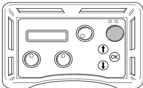
5. Impostare il flusso per il movimento del gruppo su max girando il comando sul telecomando in senso orario.
