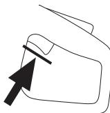
Stlačte zámok spínača a skontrolujte, či sa pri uvoľnení vráti do východiskovej polohy.
