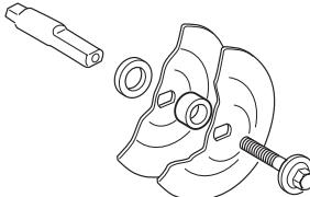
Nepoužívajte prírubové podložky, ktoré sú pokrivené, majú poškodené okraje, vykazujú známky poškodenia nárazom alebo sú znečistené. Nepoužívajte rôzne veľkosti prírubových podložiek.
