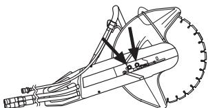
Skrutujte nastavovaciu skrutku tak, aby matica so štvorcovou hlavou vyšla oproti značke na kryte. Tým sa automaticky zaistí, že remeň je správne napnutý.
