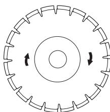
Vždy používajte ostrý diamantový kotúč. Naostrite kotúč rezaním mäkkého materiálu, ako je pieskovec alebo tehla.
