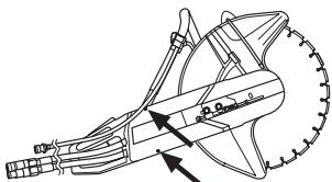
Vyberte starý remeň a nasadte nový. Nasadte rezné rameno na stroj a napnite remeň nastavovacou skrutkou. Nový hnací remeň by sa mal znova dotiahnuť približne po 30 minútach prevádzky.
