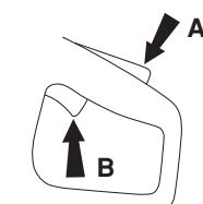
Zámok vypínača zostane stlačený, kým bude stlačený vypínač. Keď uvoľníte úchop na rukoväti, vynuluje sa spínač aj zámok vypínača. Je to zabezpečené dvomi nezávislými vrátnymi pružinovými systémami. V tejto polohe sa stroj zastaví a spínač sa zaistí.
