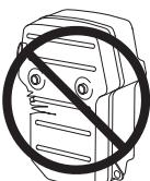
Pravidelne kontrolujte, či je tlmič výfuku pevne pripojený k motoru.
