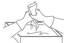
Vložte filter do plastového vrecka a vylejte naň olej. Premieste plastové vrecko, aby sa olej dostal do filtra. Pred vložením filtra do stroja vytlačte vo vrecku z filtra prebytočný olej a vylejte ho. Nikdy nepoužívajte bežný motorový olej. Tento typ oleja cez filter veľmi rýchlo presiakne a nahromadí sa v spodnej časti.
