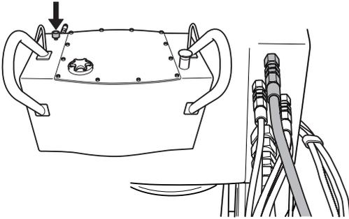
Cuando estén conectados el cable eléctrico, la manguera de agua y el conjunto de mangueras se puede poner en marcha la máquina.
