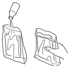
2 罩 B 下面有纸制滤清器。如果引擎的功率下降或者一到两周后，必须更换/清洗纸制滤清器。手摇清洁滤清器注意：纸制滤清器不可以清洗。注意！高压空气会损坏滤清器。
