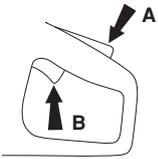
只要油门被按下，扳机锁就会保持按下。松开把手，油门扳机和油门锁将都返回到原来的位置。这是通过两个独立的复位弹簧系统来进行。这意味着油门自动地锁定在闲置位置。
