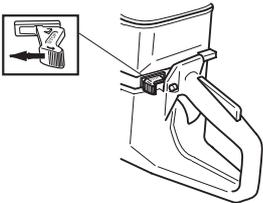
启动油门位置 - 冷引擎：完全拉出阻气门即可看到启动油门位置和阻气门。
