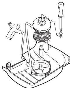
使用螺丝起子，转动启动器并取掉复位弹簧，松开钩子。钩子固定启动器上的弹簧部件。
