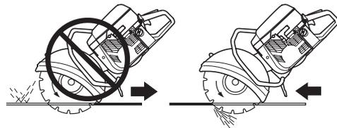
切割时总是使用极限速度。低速切割，尤其是在切割硬而薄的材料时，可以导致锯片被夹住及折断碳钨头。
