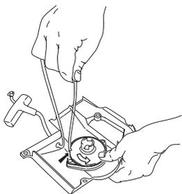
取掉剩余的旧启动器绳索并检查复位弹簧是否可以正常工作。通过启动器外壳上的孔插入新的启动器绳索，插入绳索滑轮中。
