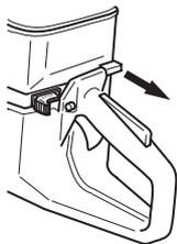
启动油门位置 - 热引擎：将阻气门开关拉到阻气门位置然后再次推它，即可得到正确的阻气门/启动油门设定。这只涉及无任何阻气门的启动油门设定。
