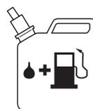
加油时请小心谨慎。启动前，请先将机器移开距离加油区至少三米的地方。检查油箱盖是否正确地锁紧。
