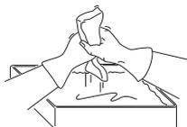
将滤清器放在塑胶袋中并倒上滤清器油。揉捏塑胶袋使油散开。挤出塑胶袋内滤清器多余的油，倒出多余的油，然后将
