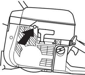
停止开关：确保停止开关（STOP）处于左侧位置。
