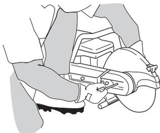
支撑锯片的螺钉的紧固扭矩为：15-25 Nm (130-215 in. lb)。
