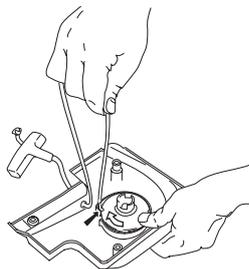
注意！当启动器的绳索完全拉出时，确定滑轮至少还可以再转 1/2 圈。
