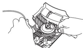
如图所示，把启动器绳索固定在滑轮上。将绳索拉紧，确保剩余末端尽可能地短。把启动器绳索另一端固定在启动器把手上。
