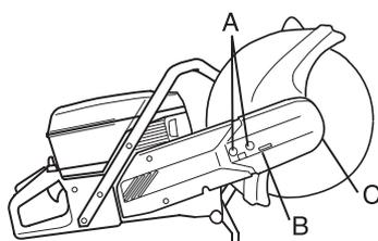
旋转张力螺钉 (B) 直到张力消失。
