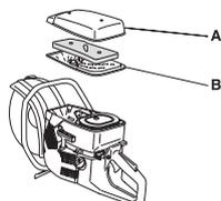
取下泡棉塑胶滤清器。用微温的肥皂水仔细清洁。然后用清水彻底清洗干净。挤干水并弄干滤清器。注意！高压空气会损坏泡棉。
