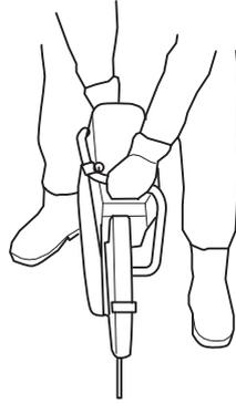
调整切割工具的防护罩使后方部分嵌入切割体。这样，防护罩才可以收集切割碎片及火花，避免伤及操作人员。
