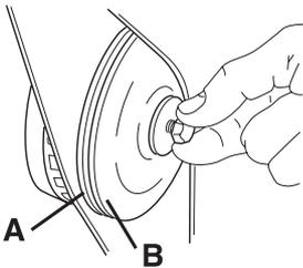
轴可以用螺丝起子、钢针等锁紧。滑到最远处。锯片顺时针方向上紧。
