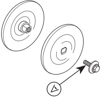
不要使用弯曲、有凹口、不整齐或肮脏的凸缘垫片。不要使用尺寸不对的凸缘垫片。
