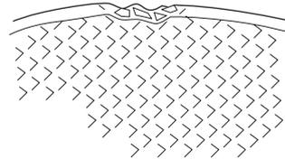
把研磨锯片挂在手指上，用螺丝起子等轻轻敲打进行测试。如果锯片没有发出清亮的共鸣声，则锯片定有破损。
