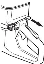
**Posición de aceleración de arranque, motor caliente:** Para la aceleración de arranque, ponga el estrangulador en la posición de estrangulamiento y, a continuación, vuelva a empujarlo hacia dentro. Esto solo activa la aceleración de arranque sin estrangular.
