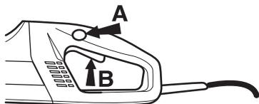
El bloqueador de interruptor permanece presionado mientras está presionado el interruptor. Cuando se suelta la empuñadura, se restablece el interruptor y el bloqueador de
