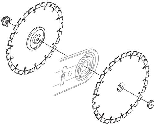
Es muy importante que los discos de corte giren cuando se aprieta la tuerca. Así se asegura que la correa no es apretada entre las mitades de polea integradas en los discos de corte cuando los discos/poleas se unen con la tuerca. Se recomienda hacer esta operación de forma intermitente; es decir, apretar un poco, girar un poco y repetir hasta que los discos están fijos.
