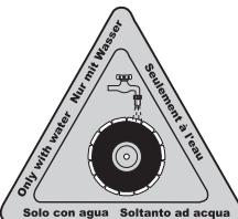
**ΠΡΟΕΙΔΟΠΟΙΗΣΗ!** Ψύξτε τους διαμαντέ δίσκους υγρής κοπής συνέχεια με νερό για να εμποδίσετε υπερθέρμανση που μπορεί να παραμόρφωσει το δίσκο με αποτέλεσμα φθορές στο μηχάνημα και τραυματισμό του χειριστή.
