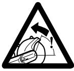
**ΠΡΟΕΙΔΟΠΟΙΗΣΗ!** Τα κλωτσήματα (τινάγματα) μπορεί να είναι αιφνίδια, γρήγορα και βίαια και μπορεί να προκαλέσουν σοβαρούς τραυματισμούς για τη ζωή. Διαβάστε και κατανοήστε τις οδηγίες του εγχειρίδιου πριν από τη χρήση του μηχανήματος.
