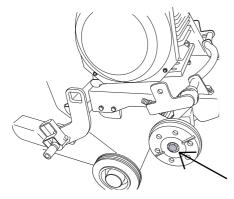
ホースホルダーを使用して、機械の電源ケーブルや水の供給管が機械の下敷きになったり、機械の進行の邪魔になったりしないようにしてください。
