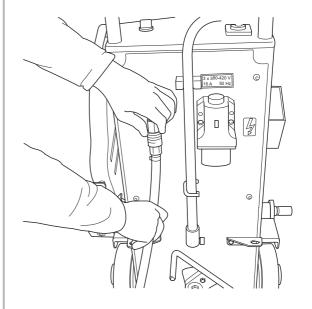
十分な冷却が行われ、粉塵の集積が防止できるよう、水冷却器を作動させます。
