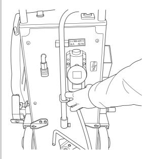
冷却器ホースを右の接続器に取り付けます。
