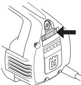
Wyłącznik służy do uruchamiania i wyłączania maszyny.
