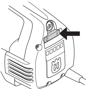
Virrankatkaisinta käytetään koneen käynnistämiseen ja sammuttamiseen.
