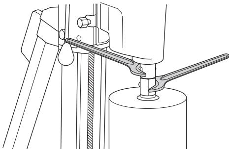
Kontrollér, at det nye bor sidder ordentligt fast, før maskinen startes.
