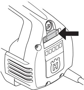
Strömbrytaren ska användas för att starta och stänga av maskinen.
