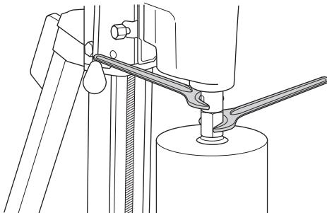
Tarkasta huolellisesti, että uusi poranterä on kunnolla kiinni, ennen kuin käynnistät koneen.
