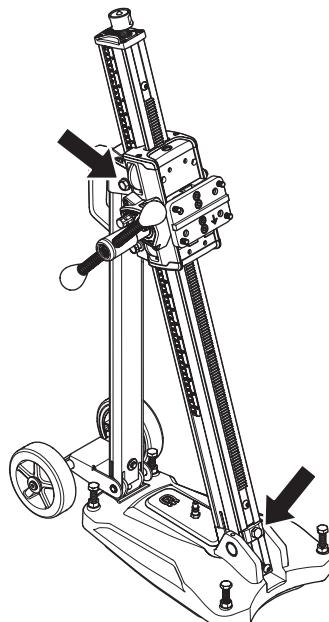
Lösen Sie die Sicherungsschrauben zur Anpassung der Säulenneigung und stellen Sie den gewünschten Bohrwinkel ein. Ziehen Sie die Sicherungsschrauben an. Verwenden Sie den Zuführungshebel. Die Säule kann um 0-60 Grad geneigt werden.
