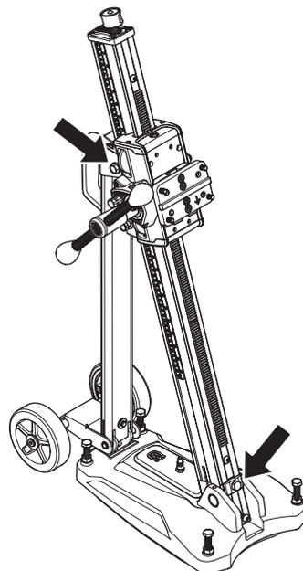
Allentare le viti di bloccaggio per l'inclinazione della colonna e impostare l'angolo di foratura desiderato. Serrare le viti di bloccaggio. Utilizzare la leva dell'alimentatore. La colonna può essere inclinata tra 0 e 60°.
