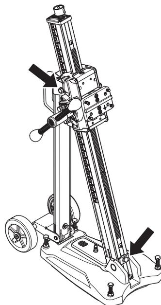
Solte os parafusos de fixação para inclinar a coluna e ajustar o ângulo pretendido de perfuração. Aperte os parafusos de fixação. Utilize a alavanca de alimentação. A coluna pode ser inclinada entre 0-60°.
