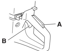
只要油门被按下，扳机锁就会保持按下。松开把手，油门扳机和油门锁将都返回到原来的位置。这是通过两个独立的复位弹簧系统来进行。这意味着油门自动地锁定在闲置位置。
