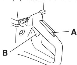
スロットルが押されている間、トリガーロックは押されたままになります。ハンドルのグリップを放すと、スロットルトリガーよりスロットルトリガーロックの両方が元の位置に戻ります。この動作は、2つの独立したリターンスプリングシステムが制御しています。この構造はつまり、アイドリング位置ではスロットルトリガーアーが自動的にロックされることを意味します。
