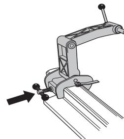
Trennschleifer mit seiner rechten Seite an der Vorrichtung montieren.
