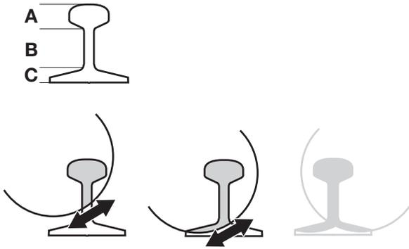
Wenn der Schnitt von einer Seite nicht beendet werden kann, muss der Trennschleifer umgedreht werden.
