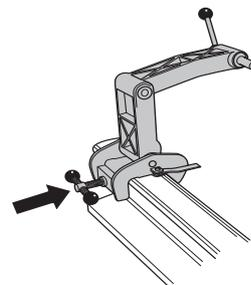
Monte la cortadora por el lado derecho en el dispositivo.
