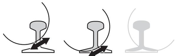
Si no se puede completar el corte de un lado, debe girarse la cortadora.
