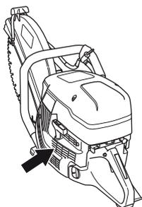
**NOTA!** Una presa d'aria di raffreddamento sporca od ostruita provoca il surriscaldamento della macchina, con conseguenti danni a cilindro e pistone.
