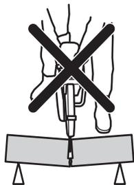
Se il disco è schiacciato o bloccato nel settore di contraccolpo, la forza di reazione respingerà la troncatrice in senso rotatorio in alto e indietro verso l'utente causando lesioni gravi o mortali.
