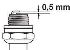
**NOTA!** Usare candele originali o di tipo raccomandato! Altre candele possono danneggiare cilindro e pistone.
