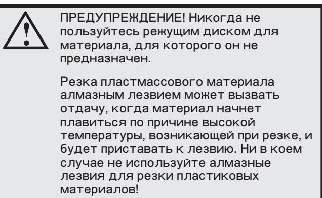
**ПРЕДУПРЕЖДЕНИЕ!** Никогда не пользуйтесь режущим диском для материала, для которого он не предназначен.
