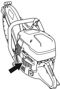
**ΣΗΜΗΙΩΣΗ!** Μία βρώμικη ή φραγμένη εισαγωγή αέρα οδηγεί σε υπερθέρμανση του μηχανήματος, κάτι που προκαλεί βλάβες στο έμβολο και τον κύλινδρο.
