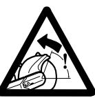
**ΠΡΟΗΙΔΟΠΟΙΗΣΗ!** Τα κλωτσήματα (τινάγματα) μπορεί να είναι αιφνίδια, γρήγορα και βίαια και μπορεί να προκαλέσουν σοβαρούς τραυματισμούς για τη ζωή. Διαβάστε και κατανοήστε τις οδηγίες του εγχειρίδιου πριν από τη χρήση του μηχανήματος.
