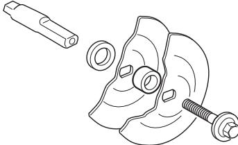
不要使用弯曲、有凹口、不整齐或肮脏的凸缘垫片。不要使用尺寸不对的凸缘垫片。
