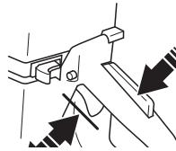
启动本机，松开电源开关，检查机器和切割锯片是否停止。
