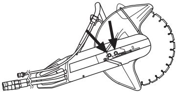
旋紧调节器螺丝，使方头螺母正好对准罩子上的符号。如此，皮带就自动具有正确的张力。
