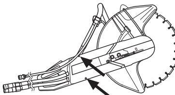
卸掉旧皮带，换上新皮带。装上切割臂，用调节器螺丝调整张力。运转大约30分钟后可以重新调整驱动皮带的张力。
