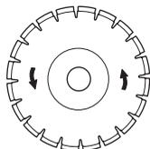
Sulla macchina si trova una freccia indicante il senso di rotazione dell'albero su cui è montato il disco.
