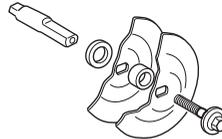
Non usare rondelle distorte, smussate, danneggiate o sporche. Non usare rondelle di diverse dimensioni.
