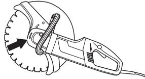
Sostituendo un disco di taglio con uno nuovo controllare le rondelle della flangia e l'albero motore. Vedere le indicazioni alla voce Controllo dell'albero motore e delle rondelle della flangia.
