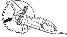
Όταν γίνεται αντικατάσταση του δίσκου κοπής να ελέγχετε τον στροφαλοφόρο άξονα και τις φλάντζες. Βλ. οδηγίες κάτω από την επικεφαλίδα Συναρμολόγηση δίσκου κοπής.
