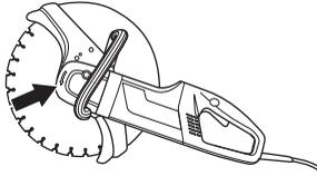
Χρησιμοποιείτε πάντοτε ακονισμένο διαμαντέ δίσκο.
