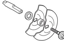
Μην χρησιμοποιείτε στραβές, χτυπημένες ή βρώμικες ψλάντζες. Μην χρησιμοποιείτε ψλάντζες διαφορετικών διαστάσεων.
