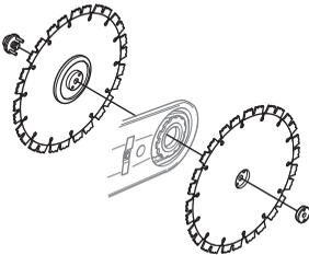
Il est très important que les lames tournent quand l'écrou est serré. Ceci indique que la courroie n'est pas coincée entre les demi-poulies intégrées des lames quand les lames/les poulies sont serrées avec l'écrou. Effectuer le serrage en alternance, c.-à-d. serrer un peu, faire pivoter et continuer ainsi jusqu'à ce que les lames soient bien attachées.
