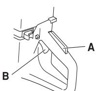
Όταν αφήσουμε ελεύθερη τη χειρολαβή, επανέρχονται και το γκάζι και η ασφάλεια γκαζιού. Αυτό ρυθμίζεται από δύο μεταξύ τους ανεξάρτητα συστήματα ελατηρίων επαναφοράς. Αυτή η θέση επιφέρει σταμάτημα του μηχανήματος και κλείδωμα του γκαζιού.
