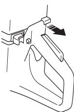
Газ в стартовой позиции – горячий двигатель: Для правильной настройки пускового устройства/газа в стартовой позиции, необходимо вытащить рычажок пускового устройства в положение всасывания, и затем вновь его придавить. Этим осуществляется только настройка газа в стартовую позицию без какого-либо всасывания.
