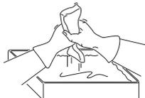
フィルタをプラスチックのバッグに入れ、フィルタオイルを上に流します。プラスチックバッグをもみ、オイルをまんべんなく広げます。プラスチックバッグ内でフィルタから余分な油を絞り、フィルタをパワーカッターに取り付け
