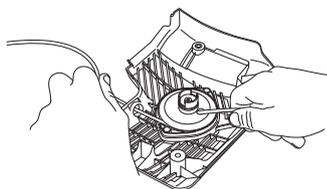
スターターロープは図を参照してローププーリーの周りにしっかり回します。しっかり結び付けて、遊びの端部分ができるだけ短くなっていることを確認します。スターターロープの端がスターターハンドルに確実に留まっていることを確認します。
