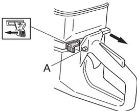
自動デコンパバルブ パワーカッターには自動デコンパバルブが搭載されており、パワーカッターの始動を容易にします。
