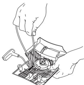
古いスターターロープの残りを取り除き、リターンスプリングが正しく作動するか確認します。新しいスターターロープをスターターハウジングの穴とローププーリーの穴に通します。
