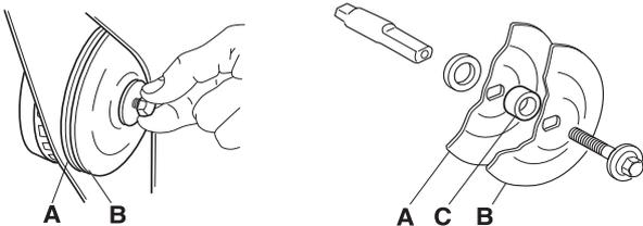
ブレードを固定するボルトの締め付けトルク値は以下の通りです。15-25 Nm (130-215 in.lb)
