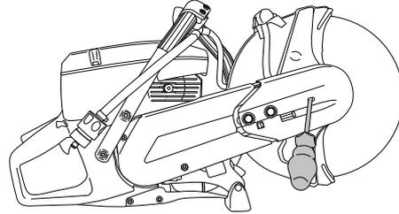
ダイヤモンドブレードをパワーカッターに装着するときは、ブレードに表記された矢印の方向にダイヤモンドブレードが回転することを確認してください。
