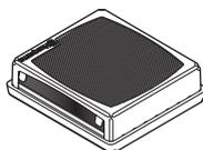
一定期間使用したエアフィルターはどんなに洗っても完全にきれいにはなりません。定期的に新しいフィルターと交換してください。破損したエアフィルターは必ず交換してください。
