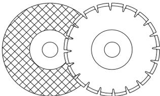
パワーカッターを運搬するときは必ずカッティングブレードを取り外してください。
