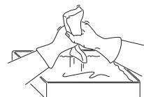
Legg filteret i en plastpose og hell på filteroljen. Kryst plastposen lett slik at oljen fordeles. Klem ut filteret i plastposen og hell ut overskuddsoljen før filteret monteres på maskinen. OBS! Bruk aldri vanlig motorolje.
