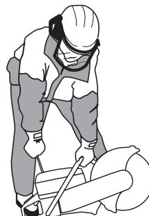
Ta tak i starthåndtaket med høyre hånd og dra langsomt ut startsnoren til du merker motstand (starthakene griper inn) og trekk deretter raskt og kraftig til.
