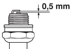
注意！スパークプラグは必ず推奨タイプのものを使用してください！不適正なスパークプラグは、ピストンやシリンダーの損傷の原因となります。
