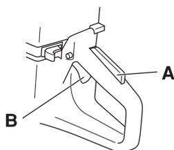
スロットルが押されている間、トリガーロックは押されたままになります。ハンドルのグリップを放すと、スロットルトリガーとスロットルトリガーロックの両方が元の位置に戻ります。この動作は、2つの独立したリターンシステムが制御しています。この構造はつまり、アイドル位置ではスロットルトリガーが自動的にロックされることを意味します。
