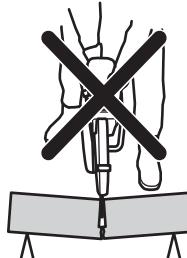
Ak sa kotúč zasekol alebo uviazol v zóne spätného nárazu, reakčná sila rotačným pohybom vyhodí rozbrusovaciú pílu dozadu smerom na používateľa a môže spôsobiť vážne alebo dokonca smrteľné zranenie.
