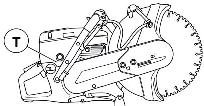
Odporučané otáčky pri voľnobehu: 2700 rpm
