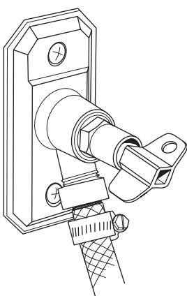
Se l'utensile non necessita di acqua, l'acqua di raffreddamento deve continuare a scorrere attraverso il radiatore, quindi defluire nel più vicino scarico del pavimento.
