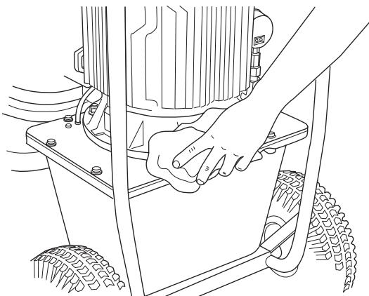
**ΠΡΟΣΟΧΗ!** Μην χρησιμοποιείτε δακτύλιο υψηλής πίεσης για να καθαρίσετε τη μονάδα ισχύος. Μην πλένετε το μηχάνημα με νερό, καθώς το νερό μπορεί να εισέλθει στο ηλεκτρικό σύστημα ή στον κινητήρα και να προκαλέσει ζημιά στο μηχάνημα ή βραχυκύκλωμα.
