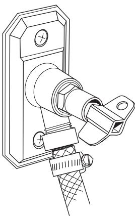
Caso a ferramenta não requeira água, a água de arrefecimento deverá mesmo assim passar através do radiador e depois para a boca de recolha de águas residuais mais próxima.
