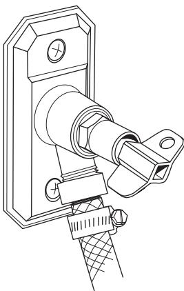
Als voor het gereedschap geen water nodig is, moet het koelwater toch door de radiator en vervolgens naar de dichtstbijzijnde vloerafvoer stromen.
