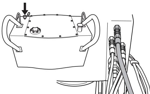
När strömkabeln och vattenslangen och slangpaketet är anslutna kan maskinen startas.
