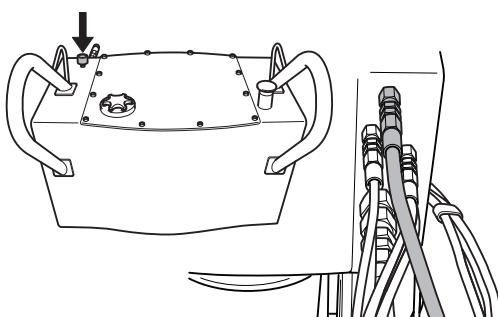
Når strømkabelen og vannslangen og slangepakken er tilkoplet, kan maskinen startes.
