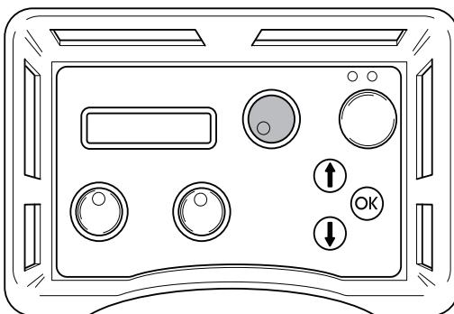
Vannmengden kan justeres manuelt med rattet på aggregatets overside.
