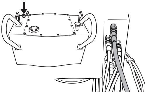
Quand le câble électrique et le tuyau d'eau et le paquet de flexibles sont connectés, la machine peut être démarrée.
