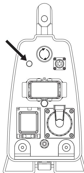
De waterklep in de aandrijfunit is nu gesloten. Deze klep gaat weer open wanneer de schijfrotatie wordt gestart.
