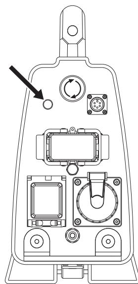
A válvula hidráulica na unidade de alimentação é agora fechada. A válvula abre novamente quando a rotação da lâmina é iniciada.
