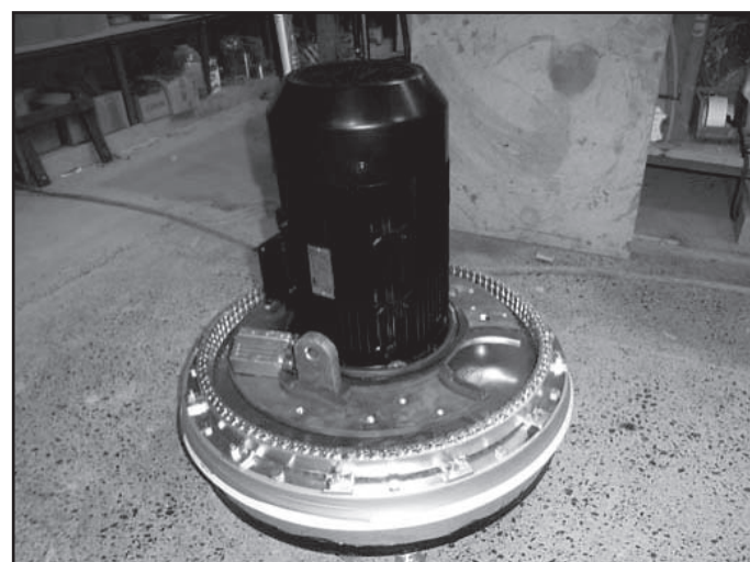
Deckplatte abheben und Zustand von Kette und Planetendichtung kontrollieren
