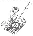
Startvorrichtung drehen, die Haken mithilfe eines Schraubenziehers lösen und die Rückzugfeder entfernen. Die Haken halten das Rückzugfederpaket an der Startvorrichtung.
