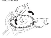
HINWEIS! Es ist überaus wichtig, das sich die Klingen beim Anziehen der Mutter drehen. Damit wird gewährleistet, dass der Riemen nicht zwischen den integrierten Riemenscheibenhälften an den Klingen eingeklemmt wird, wenn die Klingen bzw. Riemenrollen per Mutter angezogen werden. Ein Anziehen sollte wechselweise erfolgen: leicht anziehen, die Klingen drehen und erneut anziehen, bis die Klingen fest angebracht sind.
