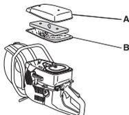
Retirer le filtre en mousse plastique. Nettoyer soigneusement le filtre dans de l'eau savonneuse tiède. Après le nettoyage, rincer soigneusement le filtre dans de l'eau propre. Essorer le filtre et le laisser sécher. **REMARQUE !** Un air comprimé présentant une pression trop élevée risque d'endommager le caoutchouc mousse.
