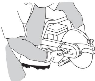
La vis qui maintient le disque de coupe doit être serrée selon un couple de 15-25 Nm.
