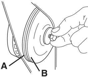
L'arbre peut être verrouillé en introduisant un tournevis, une tige en acier ou un objet similaire aussi loin que possible. Serrer le disque dans le sens des aiguilles d'une montre.
