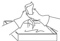
Mettre le filtre dans un sac en plastique et verser l'huile pour filtre dessus. Pétrir le sac en plastique pour bien distribuer l'huile. Presser le filtre dans son sac et jeter le surplus d'huile avant de reposer le filtre dans la machine. Ne jamais utiliser de l'huile moteur ordinaire. Celle-ci traverse le filtre assez vite et s'accumule au fond.
