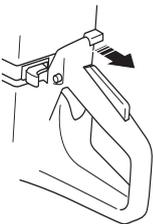
**Position ralenti accéléré - moteur chaud :** Pour procéder au réglage du starter/ralenti accéléré, il convient de tirer la commande du starter sur la position starter puis de la pousser de nouveau. Cela ne concerne que le réglage du ralenti accéléré, pas le starter.
