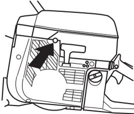
**Bouton d'arrêt:** Veiller à ce que le bouton d'arrêt (STOP) soit sur sa position de gauche.
