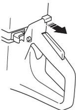
**Starthebelposition bei warmem Motor:** Mit dem Kombinationshebel Choke/Startgas erhält man Startgas, indem der Hebel in Choke-Lage gezogen und gleich wieder eingeschoben wird. Auf diese Weise erhält man Startgas ohne Choke.
