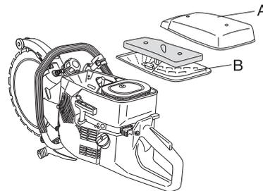
Um eine optimale Filterleistung zu erzielen, muss der Filter regelmäßig ausgetauscht oder gereinigt und eingeölt werden. Zu diesem Zweck wurde ein spezielles HUSQVARNA-Öl entwickelt.
