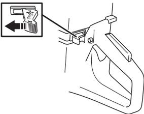
**Starthebelposition bei kaltem Motor:** Startgas und Choke werden durch vollständiges Ausziehen des Chokes erreicht.
