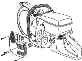
Das Seil etwa 30 cm herausziehen und in die Aussparung in der Außenkante der Seilrolle ziehen. Wenn das Seil intakt ist: Die Federspannung durch langsames Rückwärtsdrehen der Rolle lockern.
