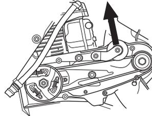
**ACHTUNG!** Darauf achten, dass die beiden Riemenrollen sauber und unbeschädigt sind, bevor ein neuer Antriebsriemen angebracht wird.
