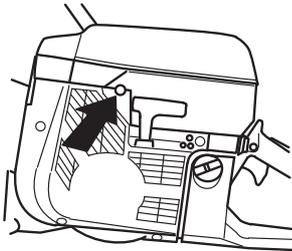
**Stoppschalter:** Sicherstellen, dass sich der Stoppschalter (STOP) in linker Stellung befindet.
