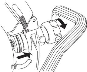
Die Führungsrolle ist in den Drehknopf eingedrückt. Um die Führungsrolle zu lösen, den Drehknopf weiter drehen, bis er sich ganz löst.
