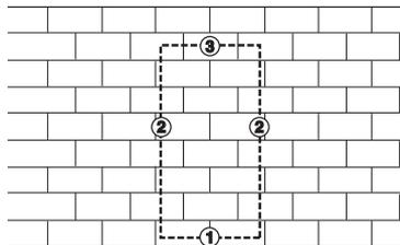
**ACHTUNG!** Wird der obere waagrechte Schnitt vor dem unteren waagrechten Schnitt ausgeführt, fällt das Werkstück auf die Klinge und klemmt sie ein.
