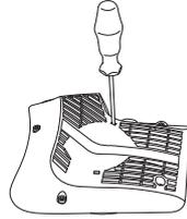
Darauf achten, dass die Rückzugfeder fest gespannt im Startvorrichtungsgehäuse liegt. Sollte die Feder beim Einlegen herauspringen, wird sie von außen nach innen zur Mitte hin aufgewickelt.
