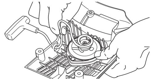
Dann am Starthandgriff ziehen, wodurch die Feder gespannt wird. Das Verfahren noch einmal wiederholen, aber dann mit vier Umdrehungen.
