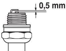
**ACHTUNG!** Stets den vom Hersteller empfohlenen Zündkerzentyp verwenden! Eine ungeeignete Zündkerze kann Kolben und Zylinder zerstören.
