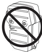
Compruebe regularmente que el silenciador esté firmemente montado en la máquina.
