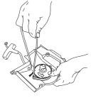
Afloje el tornillo del centro de la polea y saque ésta. Ponga un cordón nuevo en la polea y fíjelo. Enrolle unas 3 vueltas de cordón de arranque en la polea. Monte la polea contra el muelle de retorno de forma que el extremo del muelle enganche la polea. Ponga el tornillo en el centro la polea. Pase el cordón por el orificio del cuerpo del mecanismo de arranque y la empuñadura de arranque. Haga un nudo resistente en el cordón.
