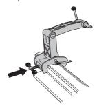
Monte la cortadora por el lado derecho en el dispositivo.
